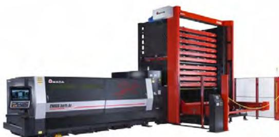
本製品は、独自開発の技術「ビーム可変ユニット」を搭載することにより、従来4kW相当の発振器が必要であった厚板を出力2kWのままで切断することを可能にするとともに、レンズ交換なしで薄板から厚板までフルレンジの連続自動加工を実現させることで、加工時間を短縮した。これにより、従来のファイバーレーザーマシンに対して消費電力を約39%削減している。
